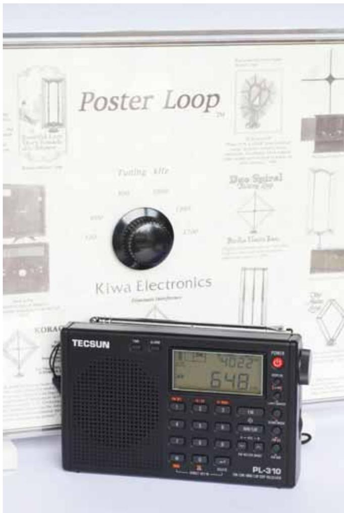
Auch ohne direkten Anschluss bringt eine induktiv angekoppelte Rahmenantenne eine deutliche Steigerung der Empfangsqualität auf Mittelwelle.
