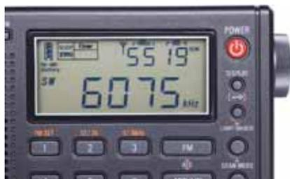
Reiseradios und tragbare Weltempfänger kommen heute größtenteils aus chinesischer Entwicklung und Produktion. Die jüngsten Modelle tragen als technologisches Herzstück einen digitalen Signalprozessor (DSP), der unter anderem für die Filterung und Demodulation empfangener Signale zuständig ist.
