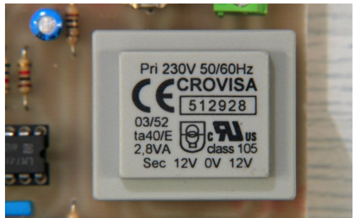
Figuur 10. Detail van de gebruikte transformator
