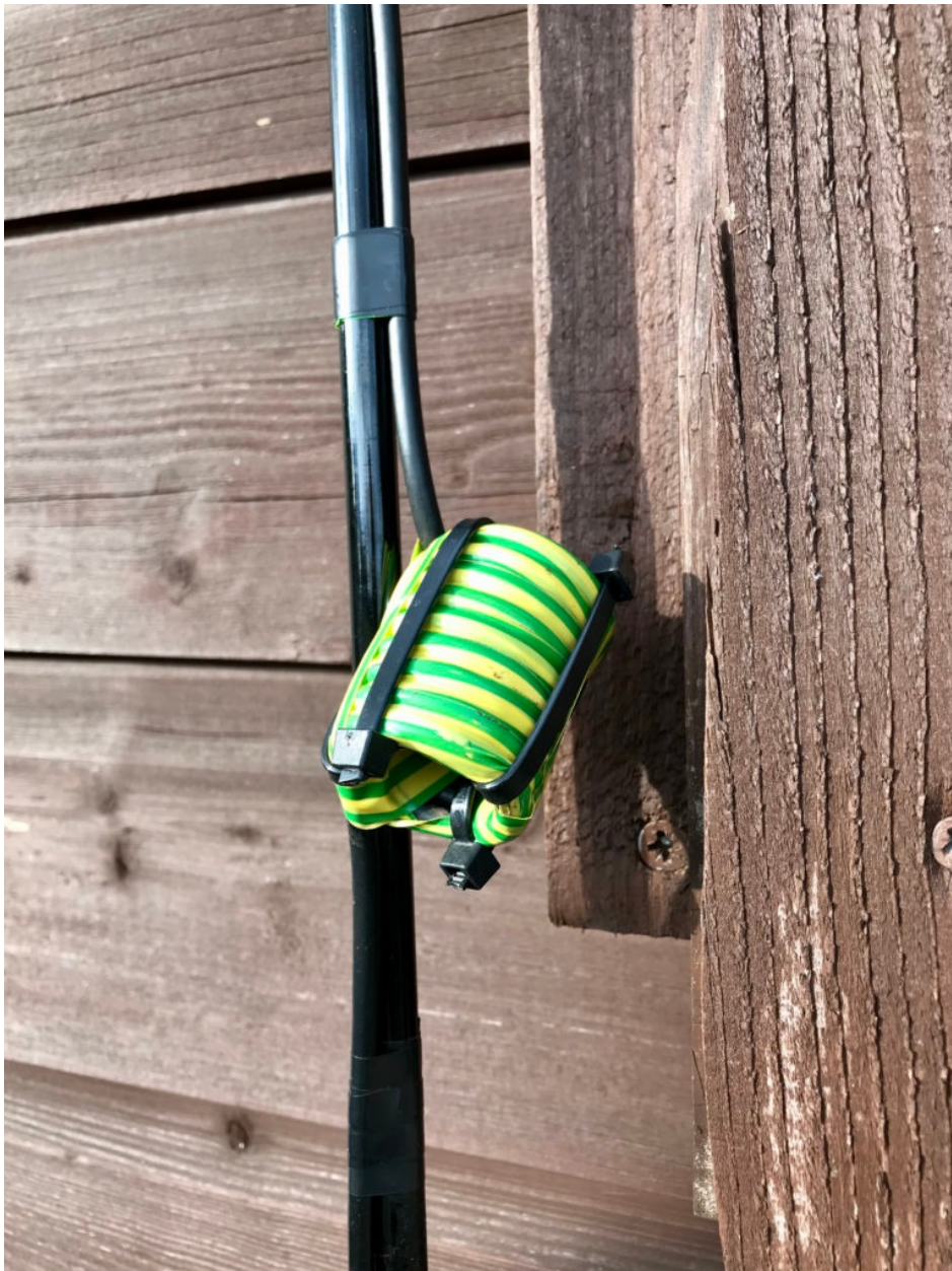
Mantelstroomspoel van 9w RG58 op 27mm vorm
