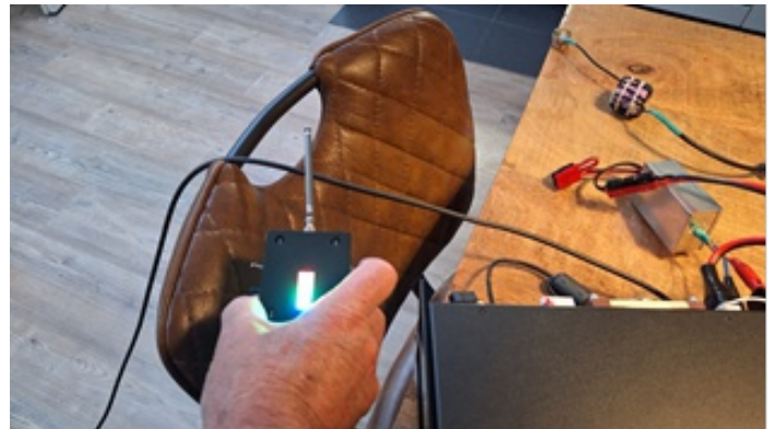
Geen mantelstroomfilter, sniffer in de buurt van de coax mantel
