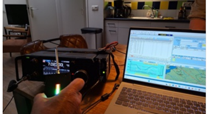
Geen mantelstroomfilter, sniffer in de buurt van de set
