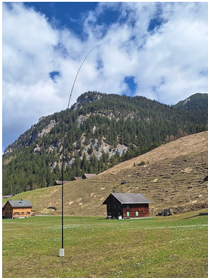
De Inverted-L antenne met de tuner onderaan de mast
